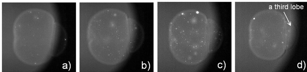
Figure 4. Laser ignition at pressures of: a) 0,1 MPa; b) 0,2 MPa; c) 0,3 MPa; d) 0,5 MPa
