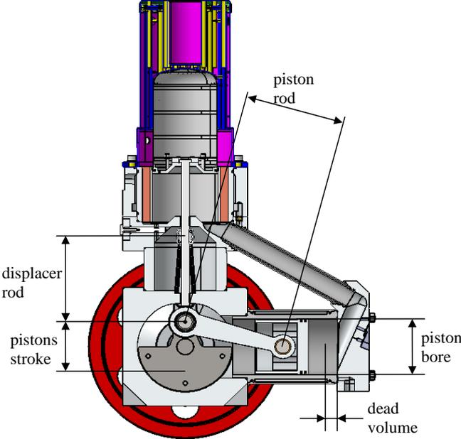
Figure 5. Engine parameters
